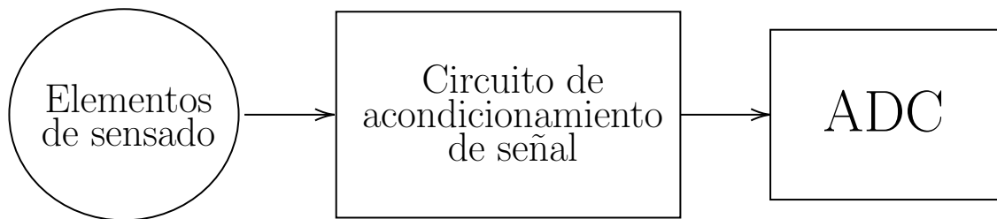
Figura 5.1.1: Etapas principales de un sistema de medición.
