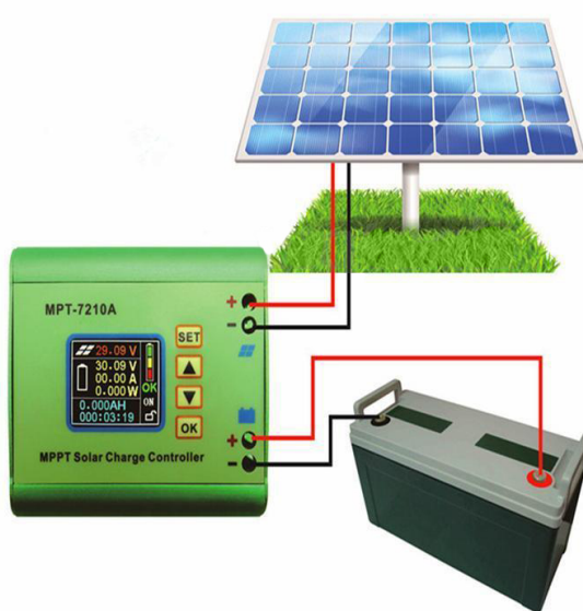
Figura 1.4.2: Diagrama de interconexión para el MPT-7210A.
