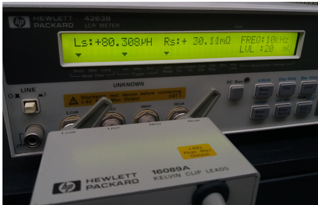
Figura 4.3.2: Medición de la Inductancia con HP 4263B.
